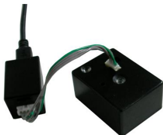
小型 9 軸ワイヤレスモーションセンサ
